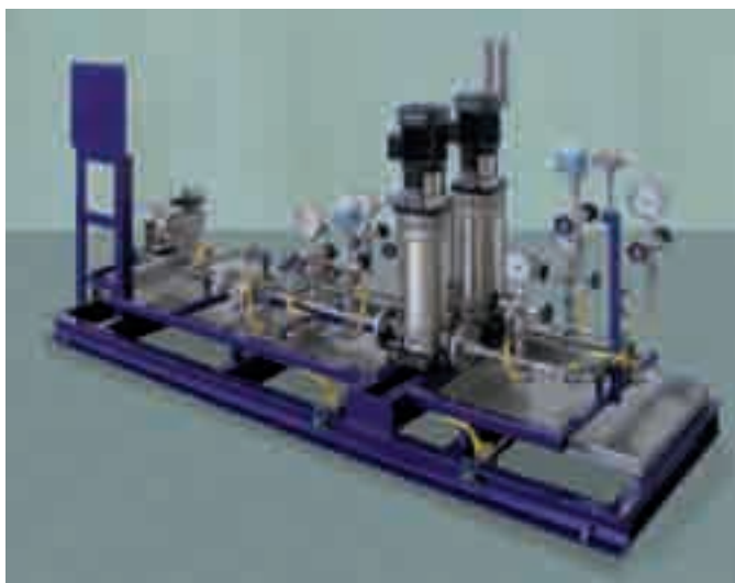
Skid de pompage
