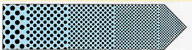
Modification de la taille des gouttelettes par variation de la pression
